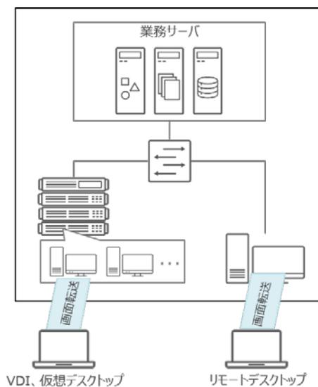
従来の方式は、複数のサーバ、PC、システムを組み合わせる複雑な構成
