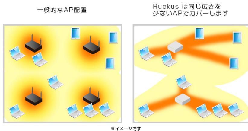
ラッカスは、無線を操作する特許技術 BeamFlex を用いて、「広くつながる、干渉に強い無線 LAN」を構築する Wi-Fi のアクセスポイントです。この技術により、他社のアクセスポイントを用いた場合に比べて、同じ範囲をより少ない個数でカバーすることができることに強みを持っております。また、WiFi6 等の次世代製品や IoT Solution 等も展開するなど、業界をリードしている会社です。
