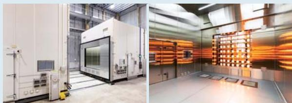
試験室は可動式のため建材の入れ替えが容易 (左)
