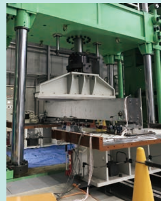
RC梁試験体を用いた疲労载荷試験
