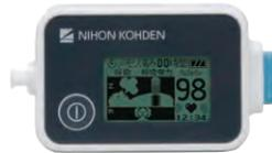
SAS-2200は、自宅で睡眠時無呼吸症候群の検査を行うための装置です。操作ボタンを一つ押すだけで、気流(圧力式)やSpO<sub>2</sub>(動脈血酸素飽和度)、いびき音、体位・体動等を測定できます。気流測定は、AASMスコアリングマニュアル\*に準拠し、より確実な測定評価を行うことができます。また、検査する項目に応じて、患者さん自身で簡単に手首または腹部への装着を行えます。
