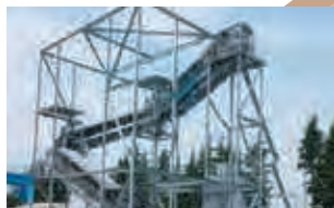
■密閉式吊下げ型コンベヤ 搬送物を密閉して自由自在に垂直搬送できます。(新規開発製品)
