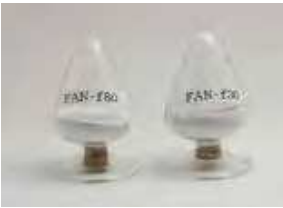
熱伝導性、熱放射性、電気絶縁性に優れ、半導体製造装置用部品や基板用材料となる窒化アルミニウム
