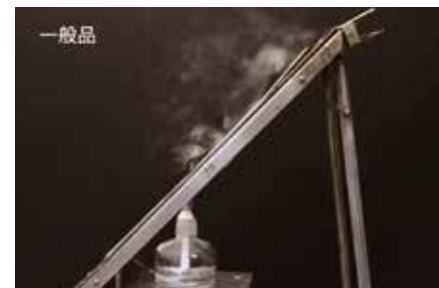
アルコールランプ加熱による発煙性テスト
