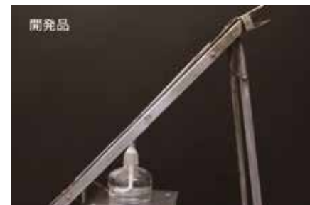
アルコールランプ加熱による発煙性テスト
