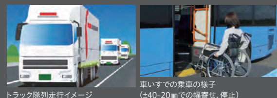
トラック隊列走行イメージ 車いすでの乗車の様子 (±40-20mmでの幅寄せ、停止) ※11 バスや小型の交通機関車両を、所定の場所(バス停等)に高精度で自動停車させる制御
