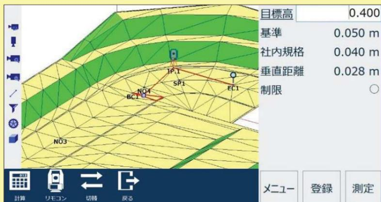
面のデータとして作成したLandXML
