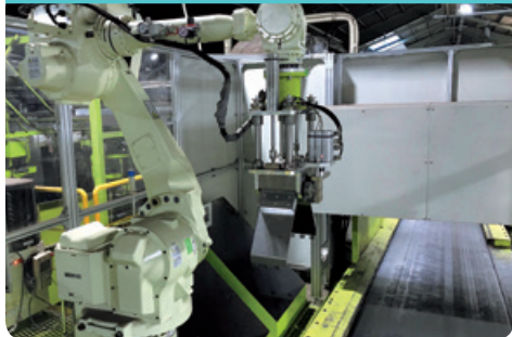
写真：廃家電解体物を種類毎にピックアップする 当社開発のロボット（中部エコテクノロジー株）
