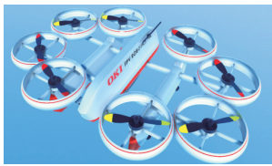
ドローン搭載型MNB測深機 (運用試作機)
