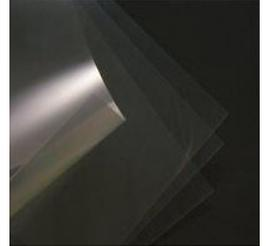
当社の反射防止フィルムはスパッタリング技術によって金属酸化膜をナノ単位の精度で形成し、優れた低反射性能を実現した製品で、大手ノート PC メーカーや多くの車載ディスプレイに採用されています。また、フィルムの最表面には指紋や汚れをつきにくくし、容易に拭き取れるようにフッ素系樹脂を用いた防汚層を設けています。
