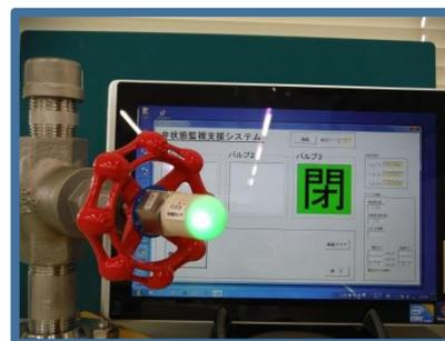
SmartiVALVE（手動弁開度表示装置）
