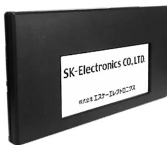
「ワイヤレス／バッテリーレス」を実現したディスプレイ機能付き電子ペーパータグ EP-01
