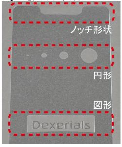
塗布厚は貼合形状にあわせて、部分的に変更できるなど、より精密かつ自由にコントロールが可能です。 車載ディスプレイで求められる厚塗りにも対応可能で、塗布厚の幅広い要求に対応することができます。 また、本開発品はソフトウエア上で塗布形状や塗布厚の変更ができるため、生産モデルの切り替えも迅 速におこなえます。 さらに、インクジェット塗布の速度がディスペンス塗布やスリット塗布に比べて速 いことも相まって、生産性も向上します。
