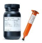
当社の光学弾性樹脂 "S V R" (以下、SVR) はディスプレイパネル表示部とトッププレートの間にあるエアギャップを埋めるアクリル樹脂で、トッププレートの材質に近い光学特性を付与することでエアギャップの界面での光の反射を防ぎ、視認性向上を実現するとともに、衝撃吸収性をもたらす液状接着剤 (OCR/LOCA) です。2007 年の上市以来、スマートフォンやタブレット PC、車載ディスプレイなど、多くのディスプレイに採用されてきました。2013 年には UV 仮硬化させた後に貼合することで作業性を向上させた "Hybrid S V R" (以下、HSVR) を上市しています。
