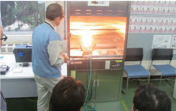
新潟工場にある安全道場での粉体爆発実験
