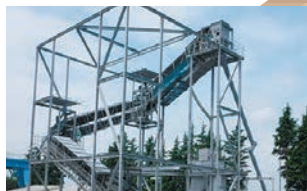
搬送物を密閉して自由自在に 垂直搬送できます。
