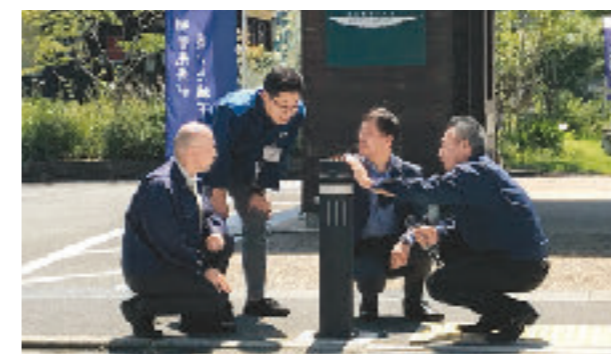
3社で共同開発を行った冠水センサー付きボラード(写真中央)。写真は福知山市での実証試験の様子。
