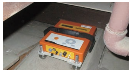
松江城 常時微動測定状況
