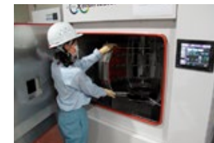
キセノンウェザーメーターによる 促進耐候性評価
