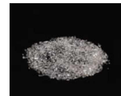
セルロース由来のバイオマスプラスチック (ポリ乳酸)
