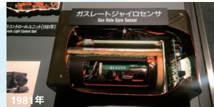
1981年 ガスレートジャイロセンサ 「世界初の自動車用地図型ナビゲーションシステムに採用」
