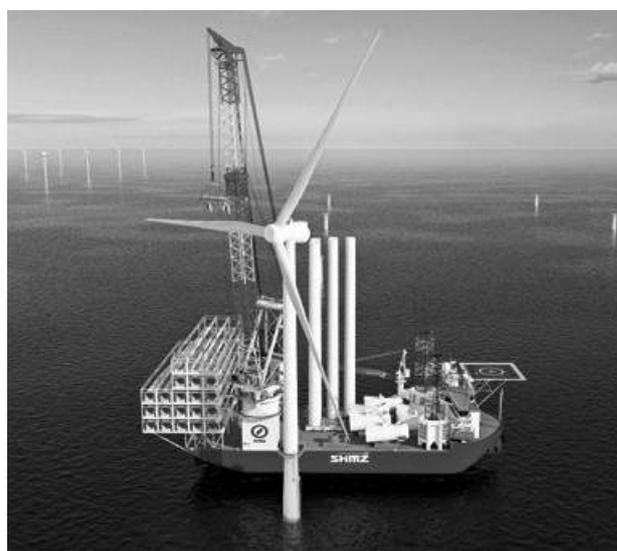
建造する自航式SEP船のパーズ(ブレード取付中)
