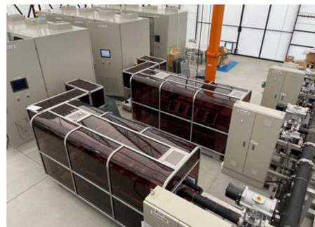
2.3MW級PEM型水電解実証機
