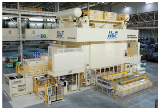
マレーシア向け自動車用プレス機械（サーボトランスファプレス）
