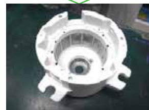
BMC成形後の巻線組み部品
