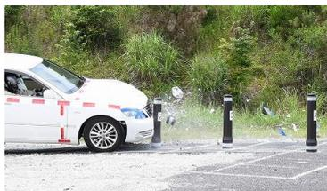
実車衝突による性能確認試験
