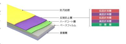
今回製品化した反射防止フィルム「HD シリーズ」は、最表面の防汚層の摺動耐久性を 40 倍以上に向上させた製品です。従来の製品は溶媒に溶かした防汚材を塗布し、ヒーターによる乾燥で溶媒を揮発させて防汚層を作るウェットコーティング法を用いていましたが、本製品は防汚材を気化させ、基材である反射防止層に直接付着させる真空蒸着法を用いることで、より高耐久かつ低摩擦で滑りのよい防汚層を形成することが可能になりました。その高い摺動耐久性から、普及が進むタッチパネルを搭載したノート PC や、タブレット形状にもなる 2in1 タイプの機器、自動車の電装化にともないニーズが拡大する車載ディスプレイなどに適しています。
