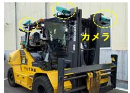
フォークリフトへのインテリジェントカメラ設置状況
