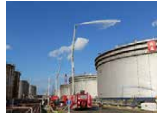
大型化学高所放水車（水島製油所）
