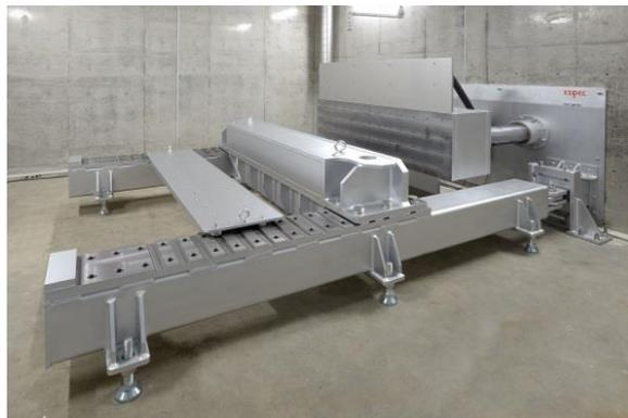
圧壊試験機(第1安全試験室)
