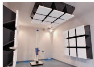
EMC 試験設備
