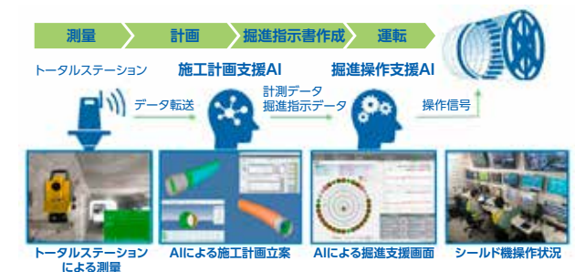
AIを活用したシールドトンネル施工 東京国際空港際内トンネル他築造等工事（東京都大田区）
