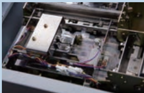
識別装置で紙幣を読み取り、瞬時に金種や真偽を判別
