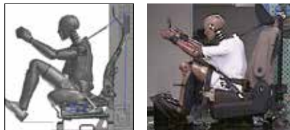
前方衝突 解析画像 前方衝突 実試験写真
