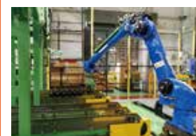
ロボットによる自動搬送や通電式焼熱処理により省人・省エネを実現（懸架ばね事業）
