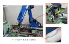
アーク溶接外観検査の自動化
