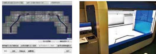
スタビライザの形状計測装置
