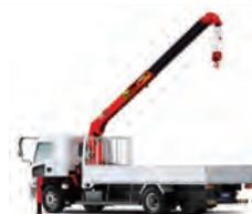
■ユニッククレーン トラックに搭載されたクレーン。建設現場などで活躍しています。
