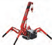
■ミニ・クローラクレーン 海外では高層ビルなどの建設現場で活躍しています。
