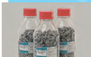
■高純度金属ヒ素 モバイル機器やレーザーの原料として使用されています。
