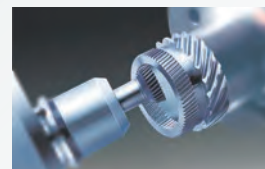
スカイピング加工で実現する小径ギヤ
