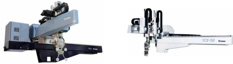
プラスチック成形品のおよそ2/3が、「射出成形」という工程で作られています。高温で溶かしたプラスチックを金型に注入した後、冷却して成形品を製造します。この金型からプラスチックを取出す専用ロボットのことを「取出口ロボット」と呼んでおり、多くの射出成形機に搭載されています。取出口ロボットは、スマートフォン内部の小型部品から自動車バン
