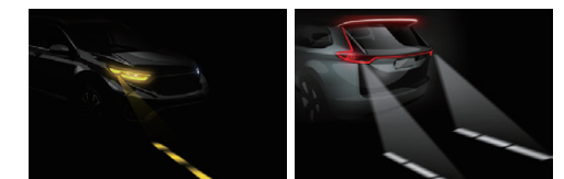
路面照射ターンランプ 見通しの悪い交差点で 車の存在を知らせる
