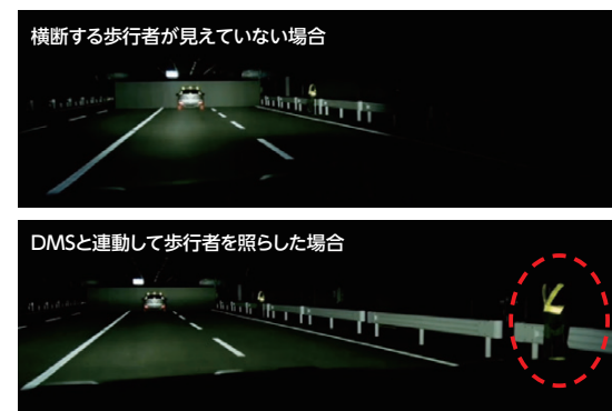
DMSと連動したヘッドランプシステム
