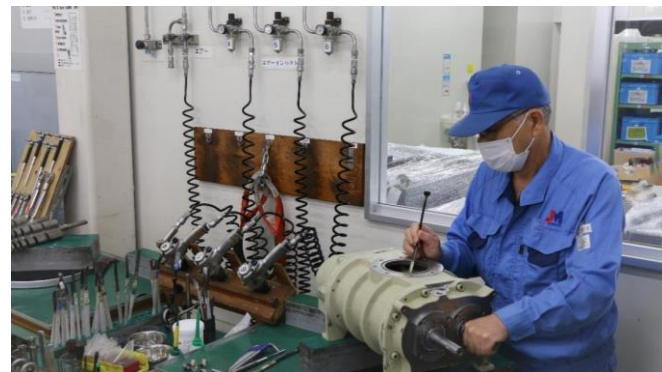
ポンプオーバーホールの様子
