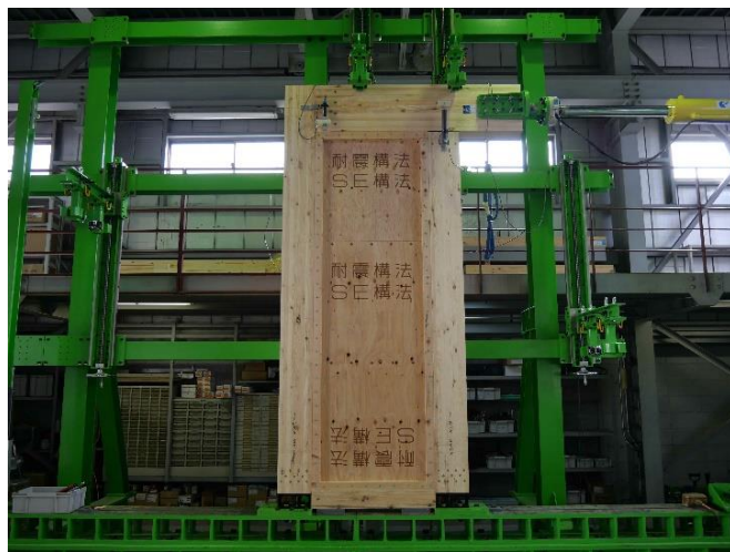
写真右：5階建ての要求性能を満足する高耐力壁の実験
