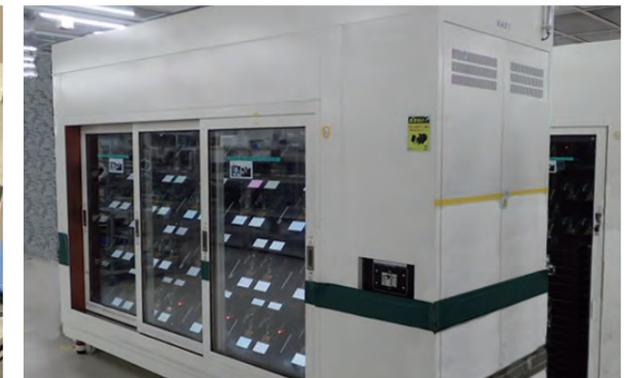
製造工程でのエージング検査
