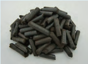
ブラックペレット：バイオマス燃料である木質ペレットを半炭化したもの
