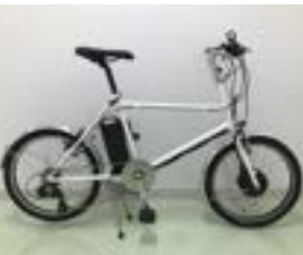
電動アシスト自転車向け 回生電動アシストシステム
