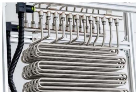
当社が開発した水冷冷却装置は、データセンター内のサーバーラックの背面に取り付けることにより、サーバーから放出される熱を、パイプ構造に水を還流する仕組みで吸収（熱交換）するものです。本製品は大手データセンター事業者のご協力を得て、現場での性能検証を実施済みです。
