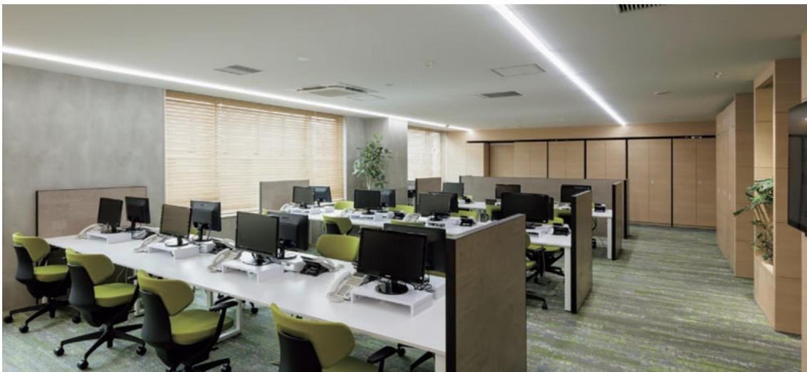
直線状に施された、シームレスな光を演出するライン照明「Linear」シリーズ。この度、さらに美しい光を追求すべく、ユニット発光面の均斉度を向上させ、端部の影を抑えることで光ムラの軽減を実現しました。ラインナップも拡充し、上下配光・下配光を選べるペンダントタイプや、幕板用の建築造作が不要で設置するだけの間接照明タイプなどを新たに発売します。R 形状や口の字型など、自由に美しい光のラインを実現します。
