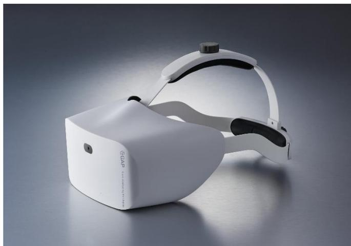
「GAP」は、最新のアイトラッキング技術により、被験者が目で指標を追うのみで視野検査ができる、全く新しい「視線分析型」の視野計です。ヘッドマウントディスプレイを採用しているため、機器の持ち運びが容易であり、従来の視野検査で使用される暗室も必要ありません。さらに、被験者は同じ姿勢を長時間保たずとも、ベッドに横たわった状態や車いすに座った状態など、楽な姿勢で視野検査を受けることができます。
