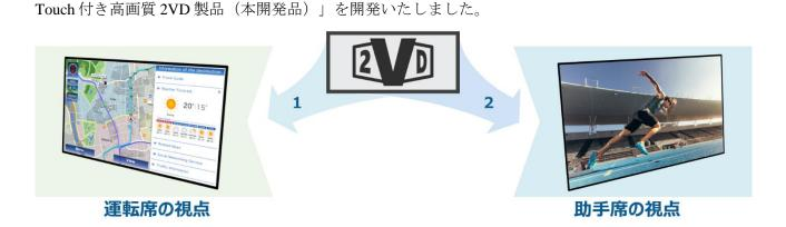
2VD は、1つのディスプレイ上に見る角度によって異なる2つの映像を表示することができる技術です。従来は画質の向上が課題でしたが、当社のLTPSと液晶パネル光学技術を活用することで、大幅な画質の向上を実現いたしました。この技術の進歩を契機として2VDの普及が進むことにより、ドライバーの安全運転をサポートする情報表示と、同乗者に対する大画面・高画質な映像表示を1枚のディスプレイで同時に提供することが可能になりました。また、車内ディスプレイの増加によってインテリアデザインに制約を与えていた問題も、2VDの導入により解決いたします。ディスプレイ数を減らすことでシンプルかつ洗練されたデザインを実現し、新たなトレンドを創出いたします。
