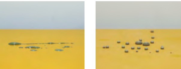
従来型枠：コンクリートのセメント分が型枠表面に付着する
