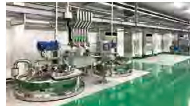
ヤマサ醤油滋賀電王工場 製造タンクおよび自動原料供給設備(滋賀県蒲生郡)
