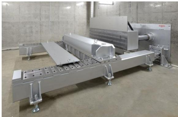
圧壊試験機(第1安全試験室)
