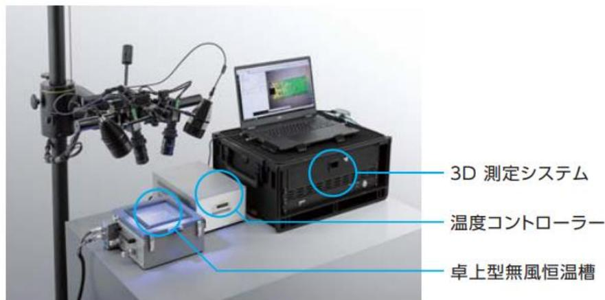
熱変形計測システム
