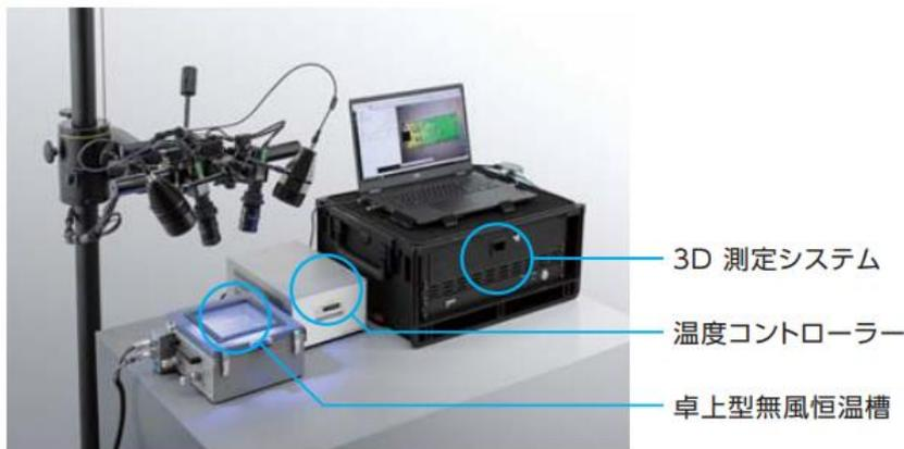
熱変形計測システム
